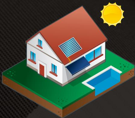
Está compuesto de una célula fotovoltaica, una batería recargable de 12V en el interior de la placa solar, que suministra la energía a un motor tubular de 12V, y un emisor vía radio. El motor se alimenta directamente de la luz solar, por lo que no es necesario disponer de toma de corriente\*
